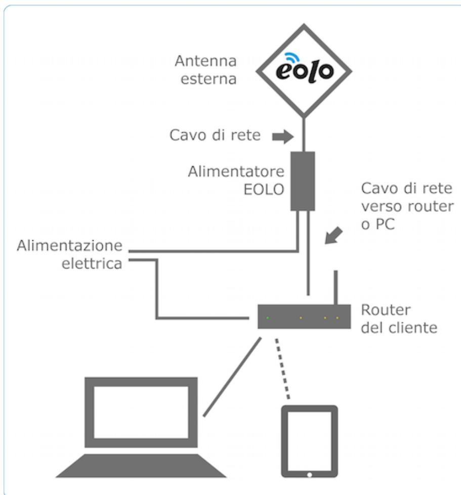
EOLO può essere utilizzato anche senza un router, collegando direttamente la scheda di rete del PC/MAC tramite cavo di rete "cross" (incrociato) all'alimentatore dell'antenna (IDU) e impostando l'autenticazione PPPoE dal sistema operativo del computer stesso.
