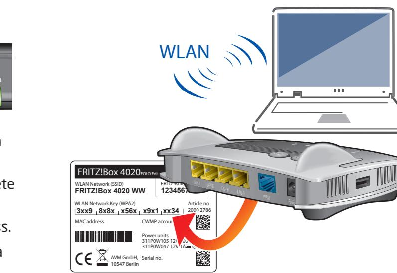
I computer che permettono la connessione wireless si possono collegare a EOLOrouter usando la chiave di rete (indicata come "WLAN Network Key") che si trova sotto il dispositivo.
