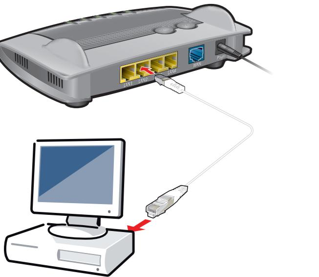
Puoi collegare il computer a EOLOrouter tramite un cavo LAN.
