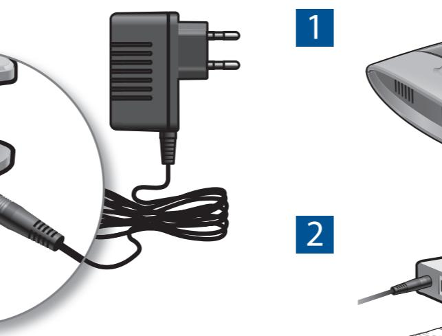
Collega EOLOrouter alla rete elettrica. Il LED "Power" inizia a lampeggiare.
